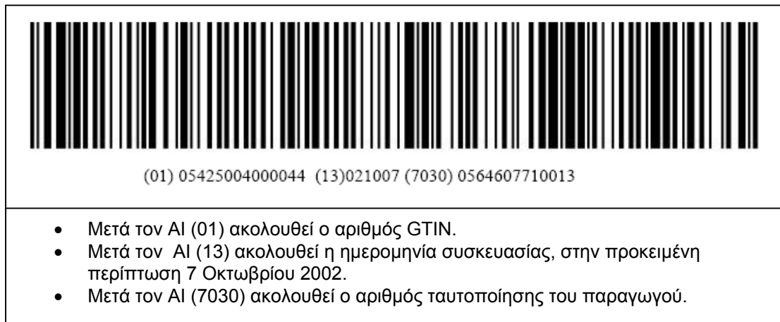
Εικόνα 11: Παράδειγμα γραμμωτού κωδικού με συμβολογία UCC.EAN-128.
